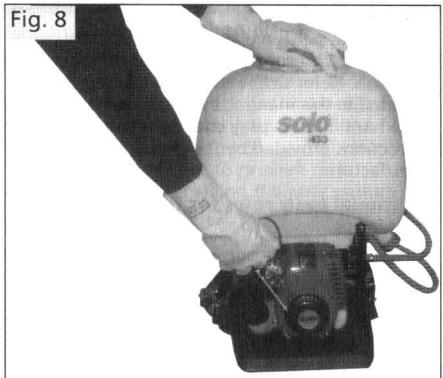
**Внимание! Не работайте на малых оборотах двигателя. Обороты должны быть не ниже  $\frac{3}{4}$  от максимальных. Регулировка давления должна достигаться не оборотами двигателя, а регулятором давления.**
