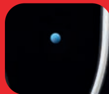
Modré svetlo naznačuje, že pripojenie Bluetooth je aktívne
