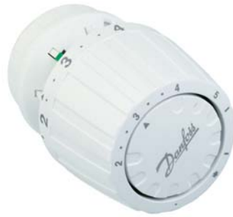
Рис.14. Термостатичний елемент типу RA 2996 з конструктивним обмеженням мінімальної нижньої межі регулювання температури повітря (діапазон налагоджування 16...28 °С)
