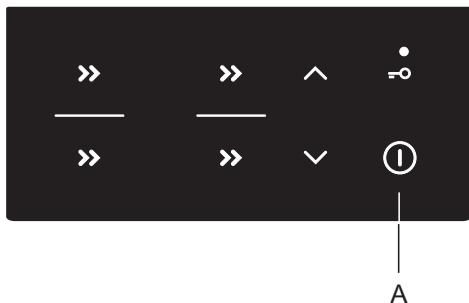
Чтобы выключить варочную панель, нажмите и удерживайте 1 секунду сенсор ВКЛ./ВЫКЛ. (A). Раздастся звуковой сигнал, и все конфорки выключатся.
