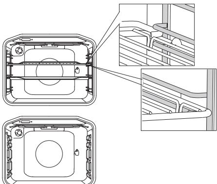
При съемных направляющих устанавливайте решетку и противни точно между двумя прутками одного уровня.
