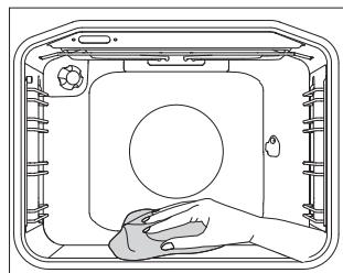
**1** Поверните ПЕРЕКЛЮЧАТЕЛЬ РЕЖИМОВ РАБОТЫ духовки в положение AquaClean. ПЕРЕКЛЮЧАТЕЛЕМ ТЕМПЕРАТУРЫ становите температуру 70°С.
