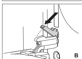
Б Откиньте фиксаторы на 90° (при плавном закрывании дверцы)
