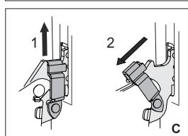
С При плавном закрывании дверцы приподнимите фиксаторы и потяните на себя.
