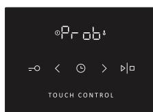
После подключения зонда установите режим нагрева и температуру. На дисплее в течение трех секунд высвечивается надпись Prob. Затем загорается индикатор (зонд) и горит все время, пока зонд подключен к духовке.
