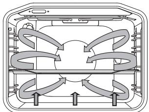
Одновременно работают нижний нагревательный элемент, нагревательный элемент вокруг вентилятора и вентилятор.
