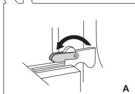
**2** А Откиньте фиксаторы до конца назад (при обычном закрывании дверцы).
