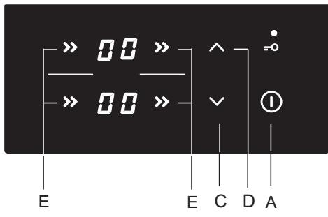
После включения варочной панели в течение 10 секунд включите необходимую конфорку сенсором Е. Сенсорами С и D выбранной конфорки установите степень нагрева. Если первым нажать сенсор С, сразу установится мощность 9. Если первым нажать сенсор D, установится мощность 1.
