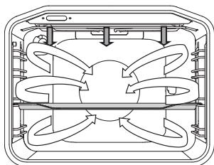
Одновременно работают инфранагреватель и вентилятор. Предназначен для приготовления мяса, рыбы, овощей.
