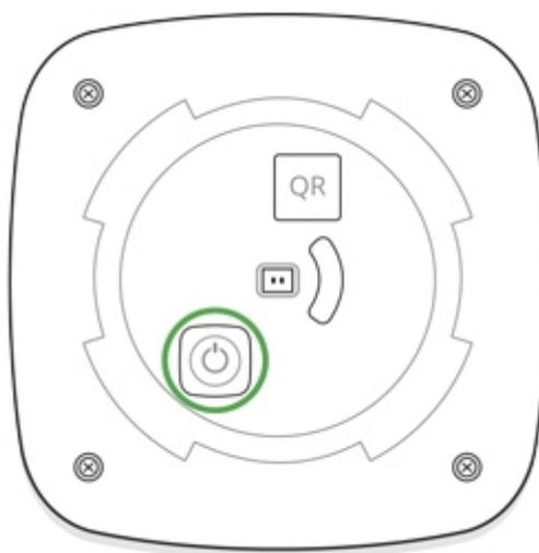
Чтобы произошло обнаружение и сопряжение, устройство должно находиться в зоне действия радиосвязи хаба (на одном охраняемом объекте). Если HomeSiren уже была привязана к другому хабу, выключите сирену и повторите стандартную процедуру добавления.
