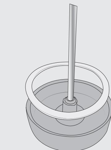
Якщо потрібно, вийміть перехідник і ущільнювальне кільце з кришки контейнера для молока. Після виймання трубки з нержавіючої стали перехідник можна легко витиснути з внутрішнього боку кришки. Очищте окремі деталі в посудомийній машині.
