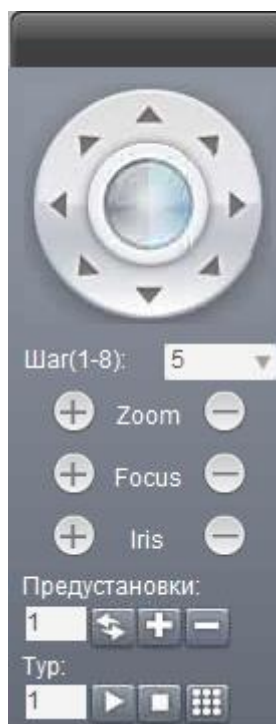
Рис. 8.0.10. Панель управления поворотными PTZ камерами.
