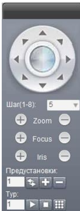
Рис. 8.0.10. Панель управления поворотными PTZ камерами.
