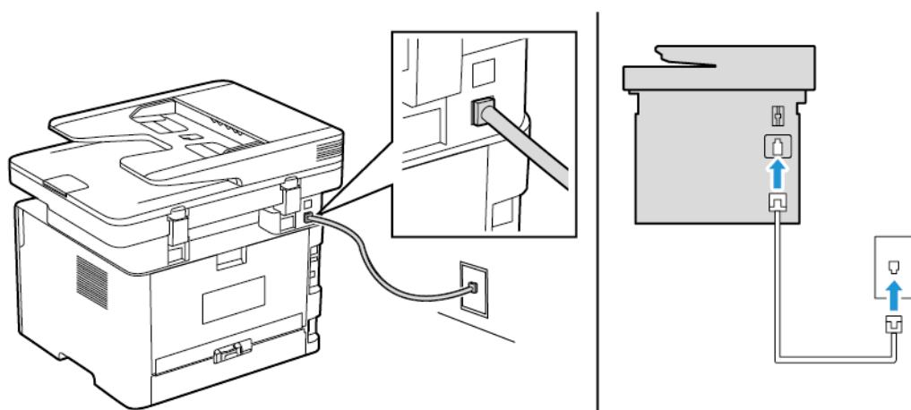
1. Подключите один конец телефонного кабеля к линейному порту принтера.
