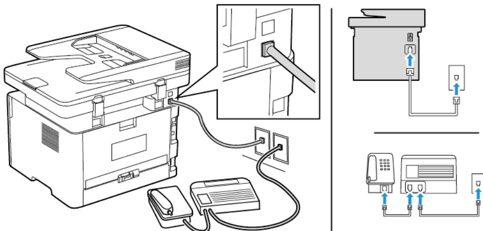
1. Подключите один конец телефонного кабеля к линейному порту принтера.
