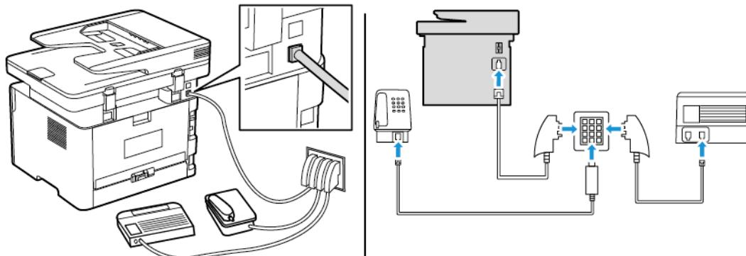
1. Подключите один конец телефонного кабеля к линейному порту принтера.
