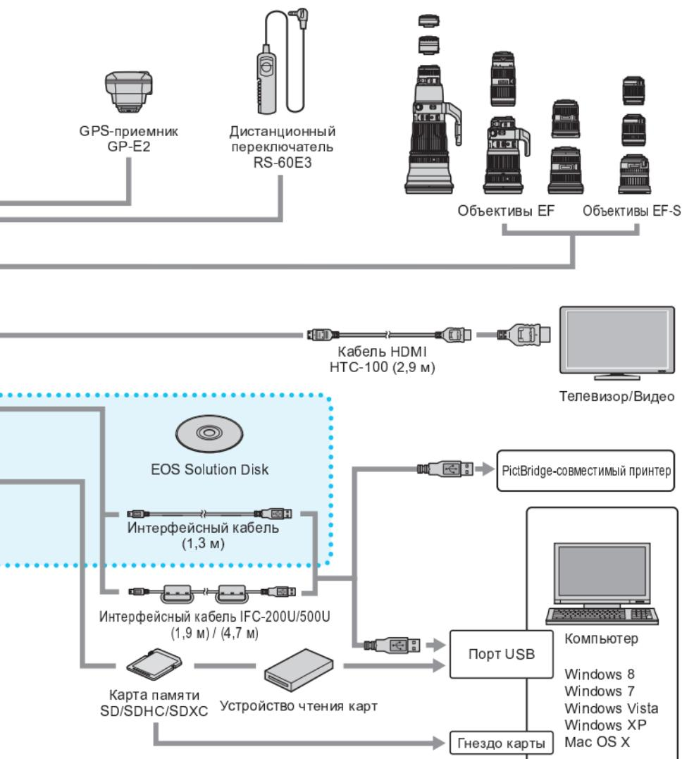
\* При использовании модуля GP-E2 с данной камерой подсоедините его к камере с помощью кабеля, прилагаемого с GP-E2.
