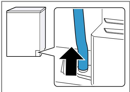
Шланг для конденсату підключений до патрубка на заводі.
