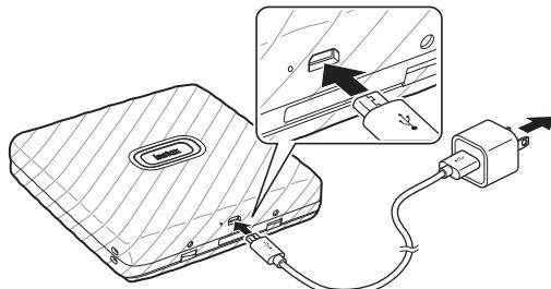
Приєднайте принтер за допомогою кабелю micro USB з комплекту постачання до USB-адаптера змінного струму (з комплекту постачання вашого смартфона), а потім підключіть адаптер змінного струму USB до електричної розетки.
