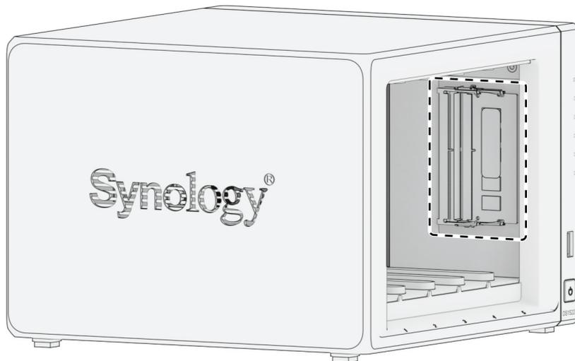
**Примечание.** После снятия лотков для дисков чувствительные внутренние компоненты остаются без защиты от внешних воздействий. Не трогайте внутренние компоненты, кроме блока памяти при его извлечении или установке.
