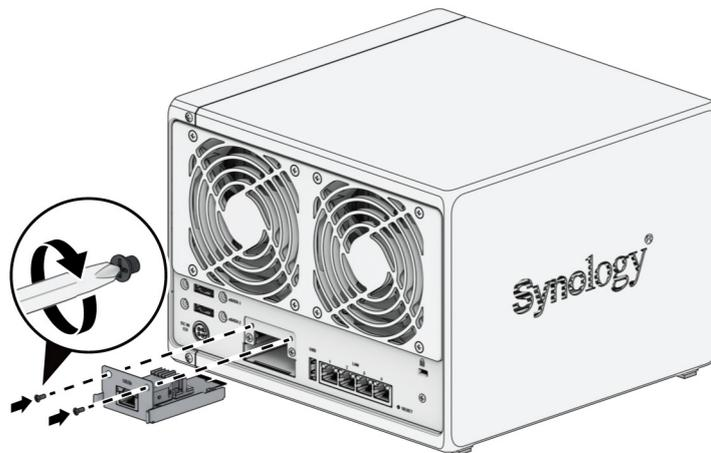
**Примечание.** Убедитесь, что сетевой модуль модернизации вставлен полностью. В противном случае могут возникнуть сбои в работе сетевого модуля модернизации.
