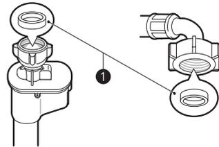
**Подключение шланга к водопроводному крану**
