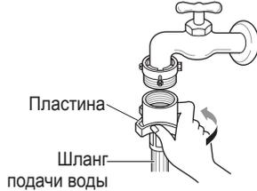
**Подключение зажимного шланга к крану без резьбы**
