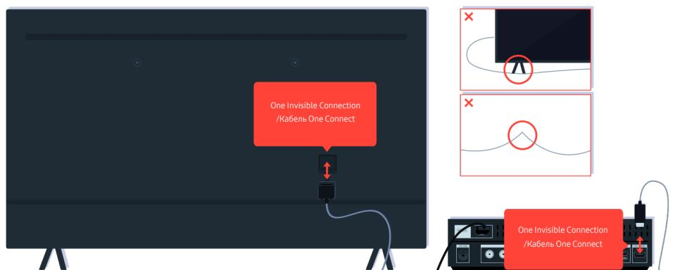
Від'єднайте та знову під'єднайте кабель One Invisible Connection або Кабель One Connect, яким TV підключено до приставки One Connect. Переконайтесь, що One Invisible Connection або Кабель One Connect не затиснуті та не зігнуті під гострим кутом.
