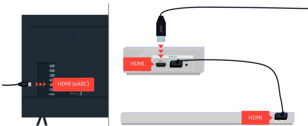
Якщо звукову панель під'єднано до приймача, а приймач під'єднаний до ТВ за допомогою кабелю HDMI, перевірте роз'єм HDMI на задній панелі ТВ. Кабель має бути під'єднано до роз'єму HDMI (eARC) на ТВ.
