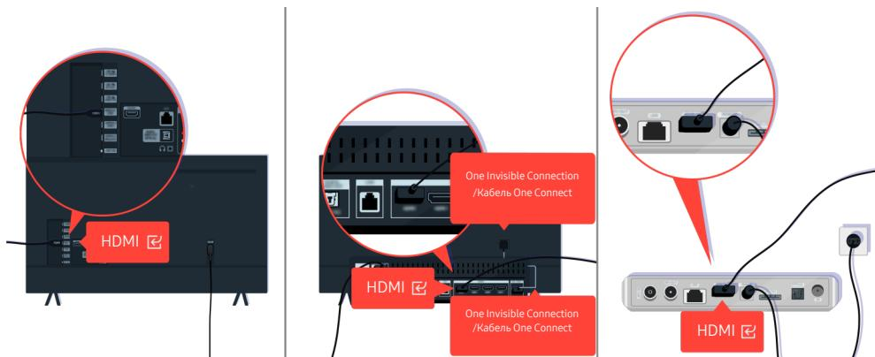
Перевірте під'єднання кабелю HDMI до ТВ або приставки One Connect.
