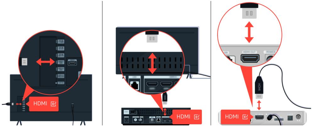
Спочатку від'єднайте та знову під'єднайте кабелі живлення й кабелі HDMI на задній панелі ТВ або приставки One Connect, а тоді від'єднайте кабель живлення від розетки і під'єднайте його знову.
