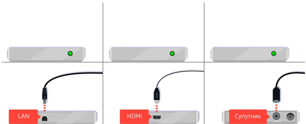
Якщо використовується декодер супутникових каналів, перевірте, чи кабель під'єднано належним чином. Який саме кабель перевіряти, залежить від типу декодера супутникових каналів.
