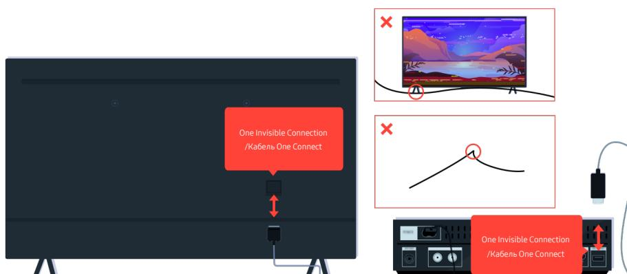
Якщо усунути проблему не вдається й для ТВ використовується One Invisible Connection або Кабель One Connect, від'єднайте та знову під'єднайте One Invisible Connection або Кабель One Connect до ТВ та приставки One Connect. Переконайтесь, що One Invisible Connection або Кабель One Connect не затиснуті та не зігнуті під гострим кутом.
