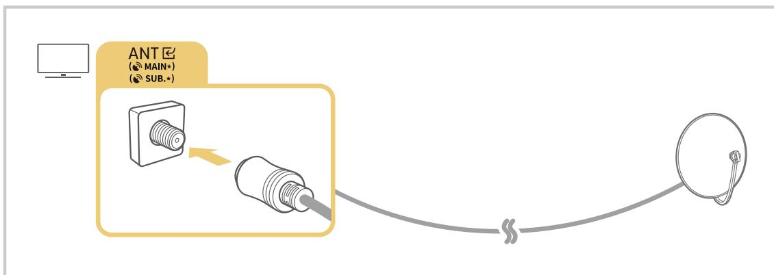
Найкраще під'єднувати обидва роз'єм за допомогою мультиперемикача, перемикача DiSEqC тощо і налаштувати для [Тип підключення антени](#) параметр [Подвійне](#).
