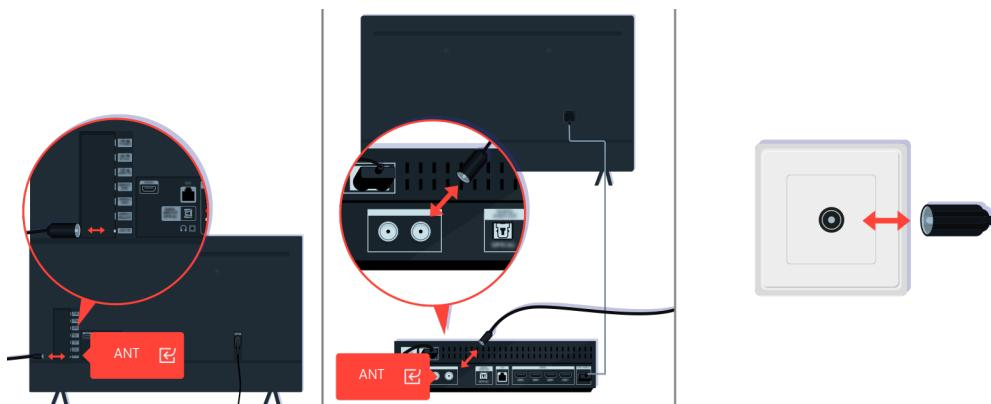
Перевірте під'єднання антени та кабелів вхідного сигналу.
