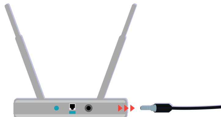
Спробуйте перезавантажити точку доступу, від'єднавши та знову під'єднавши кабель живлення. Після перезапуску повернення точки доступу в режим онлайн може зайняти від 1 до 2 хвилин.
