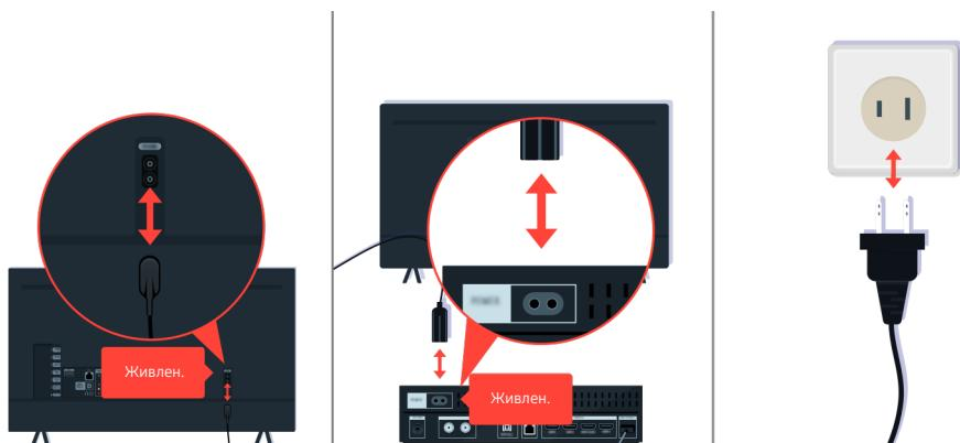
Спочатку від'єднайте та знову під'єднайте кабелі живлення й кабелі HDMI на задній панелі ТВ або приставки One Connect, а тоді від'єднайте кабель живлення від розетки і під'єднайте його знову.
