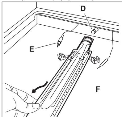
4. Плавно переместите ее влево. Убедитесь, что втулка горелки находится в сопле горелки. Не прилагайте усилия к проводу, идущему к разъему свечи зажигания (F) и к проводу термпары (E).
