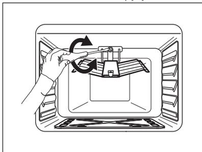
3. Соберите горелку, действуя в обратной последовательности. Прежде чем затянуть винт крепления убедитесь, что горелка правильно вставлена в заднюю панель.
