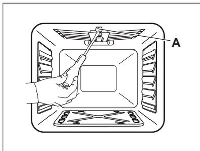
2. Выверните форсунку горелки с помощью торцевого ключа на 7 мм и замените ее на другую.
