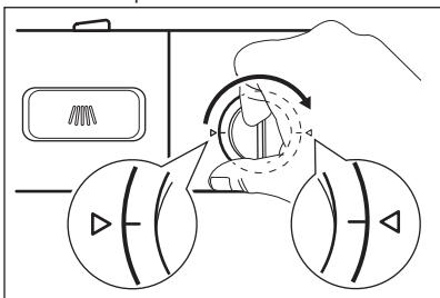
Если загорелся индикатор ополаскивателя, залейте в дозатор ополаскиватель.
