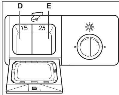
3. Закройте дозатор моющего средства. Нажмите на крышку так, чтобы кнопка блокировки защелкнулась.
