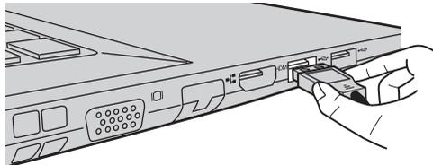
При первом подключении устройства USB к определенному порту USB на компьютере Windows автоматически установит драйвер для этого устройства. После установки драйвера можно отсоединять и подсоединять устройство без выполнения дополнительных действий.
