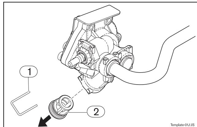
Рис 9 Опорожнение прибора
