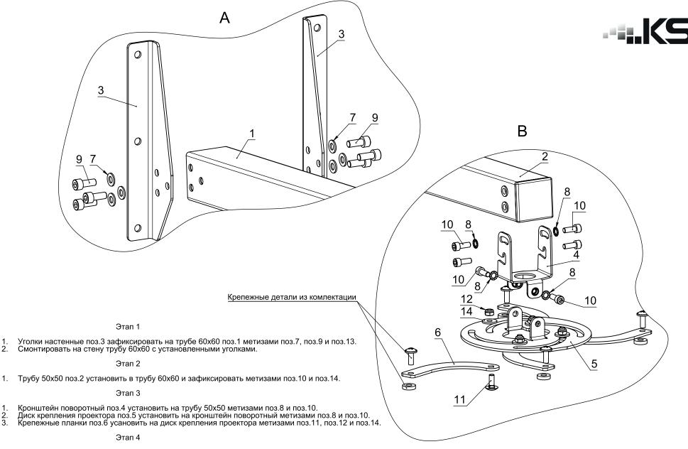
1. Проектор крепить к крепежным планкам через пластиковую шайбу, используя винты, которые входят в комплект крепежа.
