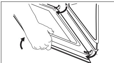
**Крок 4** Покладіть дверцята на стійку поверхню, вкриту м'якою тканину і вивільніть систему блокування для того, щоб витягти внутрішню скляну панель.
