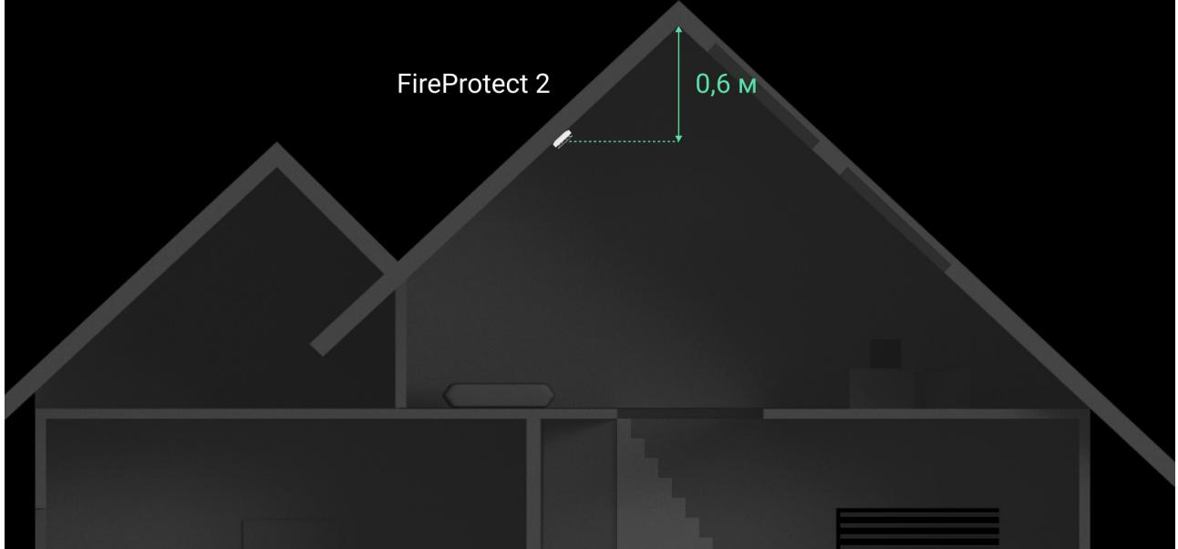
Не рекомендуємо встановлювати датчик на стіну. Таке встановлення допустиме, якщо близько розташовані балки або інші перешкоди заважають встановленню датчика на стелі. Встановлення на стіну можливе лише у випадку, якщо датчик розташовується на відстані 15–30 см нижче стелі, але вище дверних отворів.
