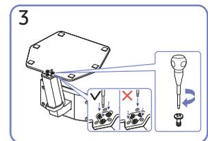
Поверніть гвинт для з'єднання внизу підставки до кінця так, щоб його було повністю зафіксовано.
