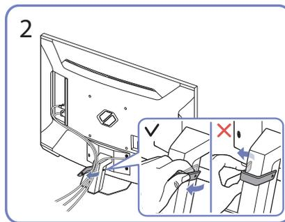
Потягніть за правий бік КРІПЛЕННЯ ДЛЯ КАБЕЛІВ НА ТРИМАЧІ ПІДСТАВКИ, щоб від'єднати від підставки. Якщо прикласти силу, можна пошкодити ліву сторону КРІПЛЕННЯ ДЛЯ КАБЕЛІВ НА ТРИМАЧІ ПІДСТАВКИ.
