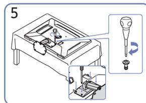
Поверніть гвинт для з'єднання внизу корпусу до кінця так, щоб його було повністю зафіксовано.
