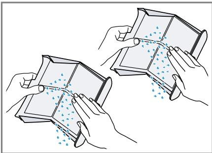
8. Ретельно промийте обидві фільтрувальні сітки під теплою проточною водою і висушіть їх.
