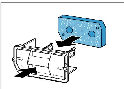
Слідкуйте за тим, щоб після очищення фільтруюча прокладка не була пошкоджена, деформована або встановлена в кріплення неправильно.
