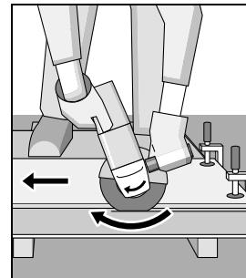
Всегда ведите электроинструмент против направления вращения. В противном случае возникает опасность неконтролируемого выхода из прорези. При резке профилей или четырехгранных труб начинайте рез на наименьшем поперечном сечении.
