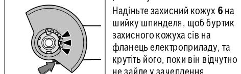
Надіньте захисний кожух **6** на шийку шпинделя, щоб буртик захисного кожуха сів на фланець електроприладу, та крутіть його, поки він відчутно не зайде у зачеплення.
