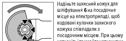
Надіньте захисний кожух для шліфування **6** на посадочне місце на електроприладі, щоб кодовані кулачки захисного кожуха співпадали з посадочним місцем. При цьому натисніть і тримайте натиснутим розблокувальний важіль **1**.
