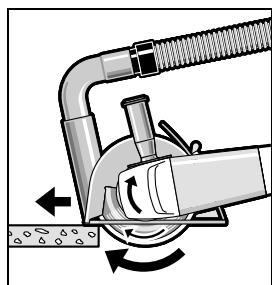
Увімкніть електроприлад і приставте його передньою частиною лунетного супорта до оброблюваного матеріалу. Помірно просувайте електроприлад у відповідності до оброблюваного матеріалу.
