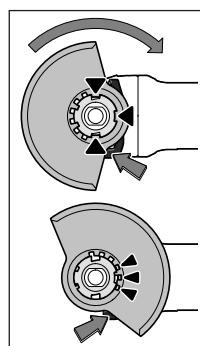
Установите защитный кожух 6 на посадочную поверхность электроинструмента так, чтобы кулачки кодирования кожуха совпали с посадочной поверхностью. Нажмите и держите при этом рычаг разблокировки 1.
