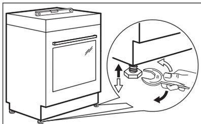
Для выравнивания по высоте верхней части прибора с другими поверхностями используйте маленькие ножи в нижней части прибора.
