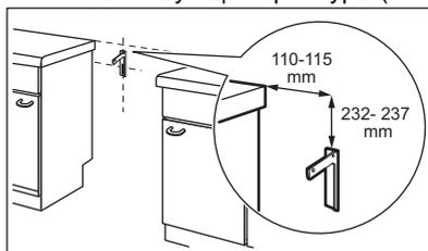
2. На задней стороне прибора находится отверстие с левой стороны. Поднимите переднюю часть прибора и поместите его в центр пространства между шкафами. Если расстояние между кухонными шкафами больше, чем ширина прибора, следует установить ее так, чтобы зазоры с обеих сторон были одинаковыми.
