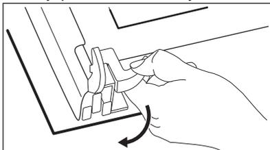
6. Поверните два фиксатора на 90° и извлеките их из своих гнезд.
