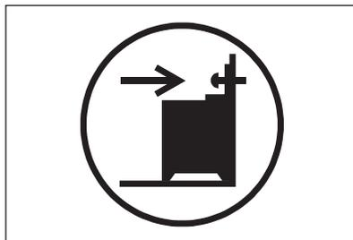
1. Захист від перекидання потрібно встановити на відстані 317 - 322 мм від верхньої поверхні приладу та 80-85 мм
