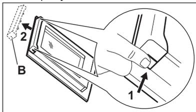
3. Чтобы снять дверную планку, нужно потянуть ее вперед.
