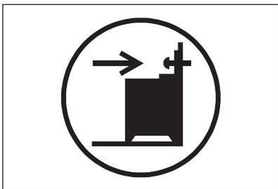
1. Установите защиту от опрокидывания на расстоянии 317 - 322 мм вниз от верхнего края прибора и на 80–85 мм от бокового края прибора в круглое отверстие на кронштейне. Привинтите его к твердому надежному материалу или прикрепите с помощью соответствующей арматуры (стены).
