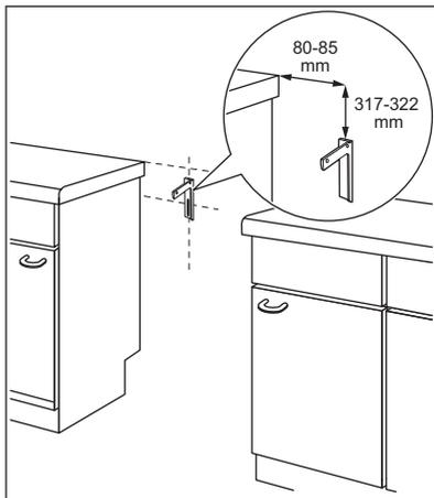
2. На задней стороне прибора находится отверстие с левой стороны. Поднимите переднюю часть прибора и поместите его в центр пространства между шкафами. Если расстояние между кухонными шкафами больше, чем ширина прибора, следует установить ее так, чтобы зазоры с обеих сторон были одинаковыми.
