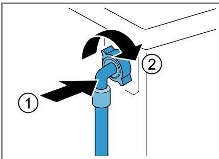
2. Підключіть шланг подачі води до крана (26,4 мм = 3/4").
