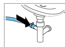
Зафіксуйте точку підключення за допомогою затискача шланга (24-40 мм).
