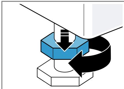
2. Щоб вирівняти прилад, поверніть ніжки приладу. Перевірте вирівнювання за допомогою ватерпаса.
