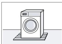
Розмістіть прилад на водо-стійкій дерев'яній плиті (товщиною не менше 30 мм), яка міцно пригвинчена до підлоги.
