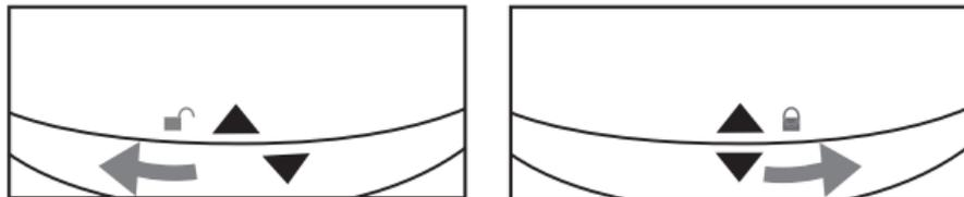
Zdejmij pokrywę komory baterii. Włóż 2 baterie AAA zgodnie z oznaczeniem. Ponownie załóż pokrywę przegrody na baterie, uważając na prawidłowe ułożenie pokrywki.
