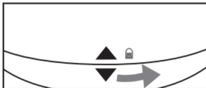
Batteriefachdeckel aufdrehen. 2 AAA-Batterien entsprechend der Markierung einlegen. Batteriefachdeckel wieder aufsetzen, auf richtige Ausrichtung achten.
