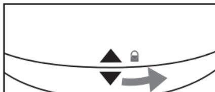
Svitare il coperchio del vano batterie. Inserire 2 batterie AAA come contrassegnato. Riposizionare il coperchio del vano batterie, rispettando l'orientamento corretto.
