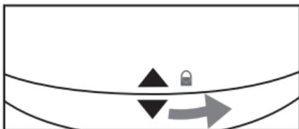
Снимите крышку отделения для батареек. Установите 2 AAA батарейки в соответствии с маркировкой. Снова установите крышку отделения для батареек. Следите за тем, чтобы крышка находилась в правильном положении.
