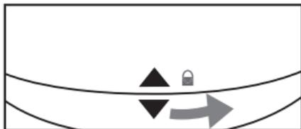
Desenroscar la tapa del compartimento de las pilas. Colocar 2 pilas AAA según las marcas. Volver a colocar la tapa correctamente.
