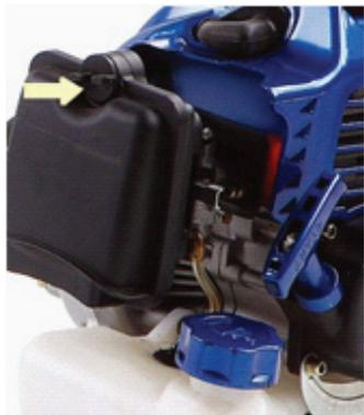
6.1.2 Вытащите воздушный фильтр и тщательно промойте его сначала в мыльном водном растворе, затем в чистой теплой воде. Высушите фильтр при комнатной температуре, перед установкой фильтра пропитайте его 2-3 каплями моторного масла.
