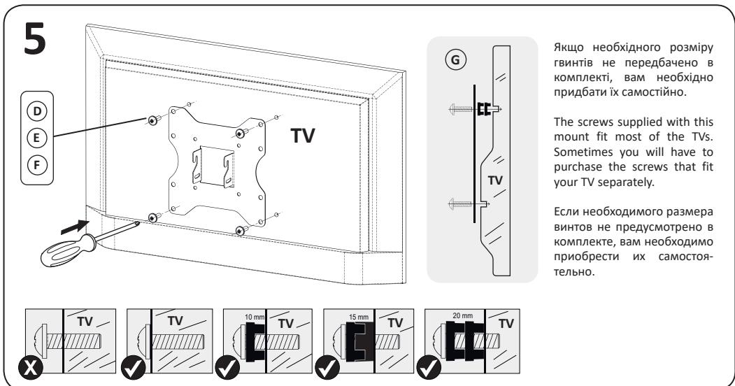
**Увага!** Після встановлення кріпильної планки перевіріти надійність її кріплення до панелі телевізору.
