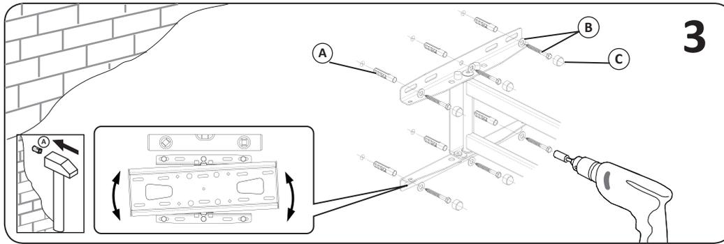
**Увага!** Після встановлення кронштейну перевірити надійність його кріплення до стіни.
