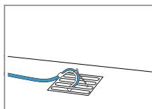
Повністю проштовхніть водовідвідний шланг через і закріпіть його кріпильним матеріалом. Закріпіть закруглене кріплення кріплення у точці відведення у каналізацію.
