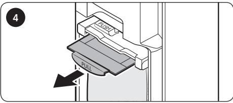
Вытяните рычаг «PULL» по диагонали и извлеките мешок для сбора пыли.
