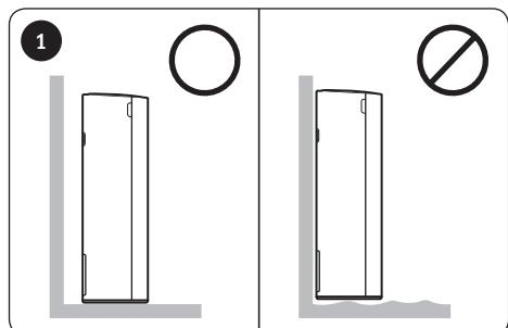
Оскільки роз'єм розташований на задній панелі виробу, не ставте виріб біля самої стіни: залиште зазор у 10 см між стіною й виробом. Установлюйте виріб на стійку й рівну підлогу.
