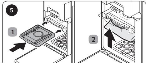
Задвиньте новый мешок для сбора пыли внутрь и с усилием нажмите снизу вверх на рычаг «PULL», чтобы он зафиксировался со щелчком.
