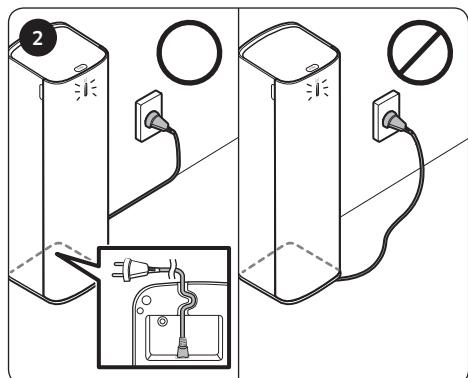
Вставьте кабель питания в канавку в нижней части станции, аккуратно уложите его вдоль стены и подключите устройство к электросети.
