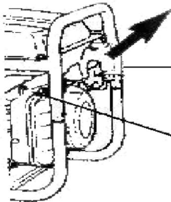
5. Повільно потягніть за шнур стартера до появи опору, утримуючи шнур стартера в натягнутому положенні, різко потягніть його.
