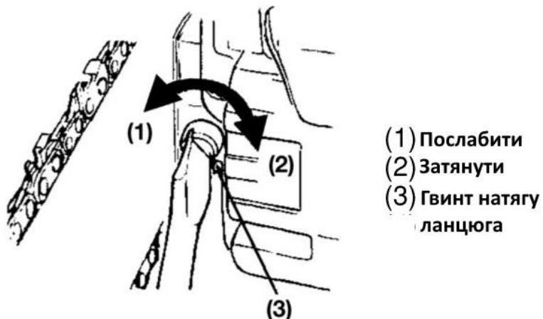
6. Затягніть гайки тримаючи пилу за шину. Зусилля затягування 12-15 Нм. Після цього, обертаючи ланцюг рукою переконайтесь, що він рухається без ривків та правильно натягнутий. Якщо потрібно, відрегулюйте знову.
