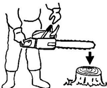
Якщо ви працюєте пилою при ввімкненому гальмі це призведе до перегріву пили та виходу з ладу.
