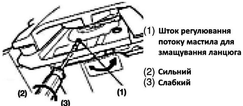
**! Попередження!!!** Бак з мастилом для змащення ланцюга може повістю спорожніти після закінчення пального в паливному баку. Не забувайте наливати масло в бак кожного разу коли заправляєте пилу пальним.
