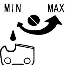
При повороті шток викруткою в напрямок стрілки вказує на положення "MAX" на ланцюг буде подаватися більша кількості масла; при його повороті в напрямку до положення "MIN", буде подаватися менше кількості масла. **Місце знаходження** : Дно силового вузла.
