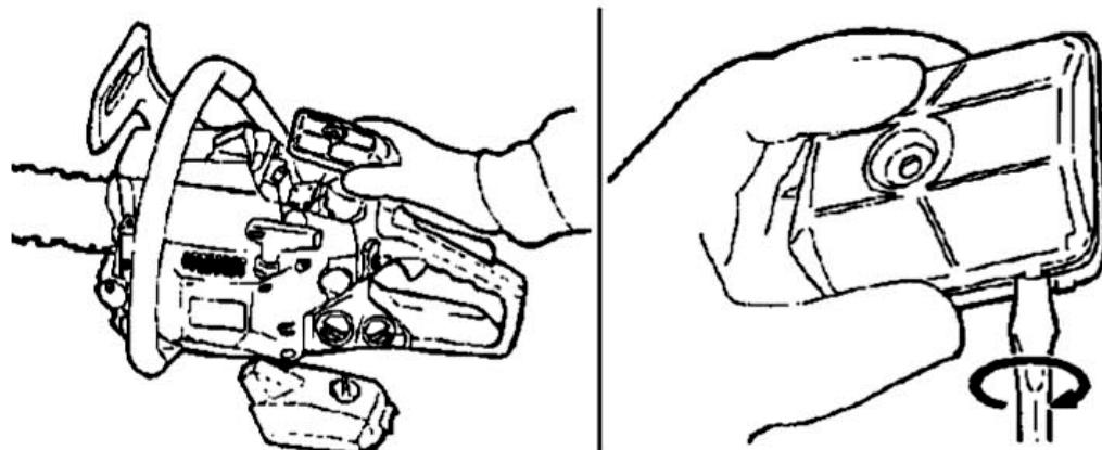
Бруд на повітряному фільтрі може бути видалений за допомогою щітки. Для очищення може бути використаний компресор.
