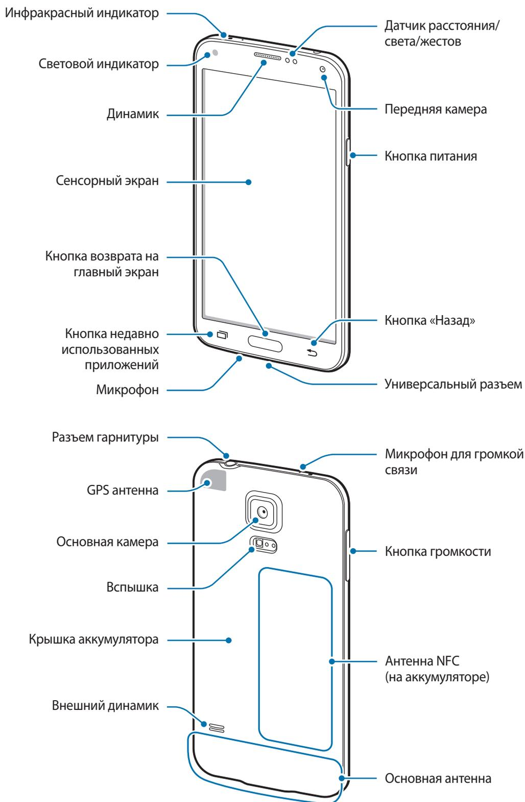
Микрофон в верхней части устройства активен только при использовании громкой связи или съемке видео.
