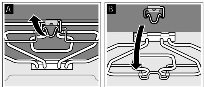
3. Після очищення нагрівальний елемент слід повернути у вихідне положення та притримати.
