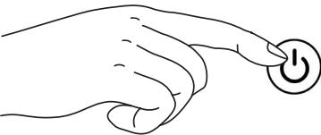
6. Stecken Sie den Netzstecker in die Steckdose. Verlegen Sie das Kabel stolpersicher. Halten Sie die EIN-/AUS-Taste (①) für fünf Sekunden gedrückt. Der Betriebsstundenzähler ist nun wieder auf 0 zurückgestellt.
