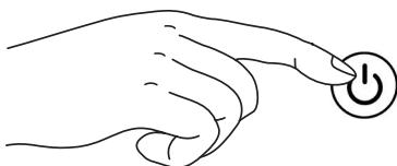
6. Fişi prize takın. Kabloyu, takılıp düşmeye yol açmayacak şekilde yerleştirin. AÇMA/KAPATMA (⊕) tuşunu beş saniye süreyle basılı tutun. Çalışma saatı sayacı sıfırlanır.
