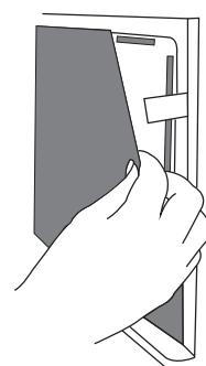
4. Insérez un nouveau filtre combiné. Pour insérer correctement le filtre combiné, orientez-vous vers les languettes comme indiqué. Placez le pré-filtre au-dessus.
