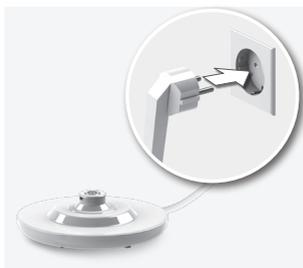
2. **Ustaw podstawę** na płaskiej, równej powierzchni. Włóż wtyczkę przewodu zasilającego do gniazdka. Niewykorzystany fragment przewodu można owinać wokół dolnej części podstawy.
