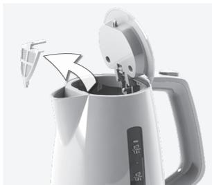
2. **Per pulire il filtro** a maglie, afferrarlo ed estrarlo. **Pulizia della piastra di riscaldamento** – sulla piastra di riscaldamento potrebbero apparire delle piccole macchie di ruggine. Rimuoverle utilizzando un prodotto di pulizia per acciaio inossidabile.
