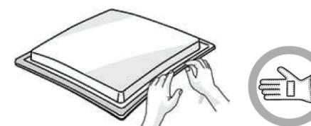
Установите варочную панель в выемку в столешнице, вырезанную по размерам, указанным в Руководстве.
