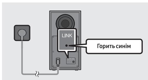
Після встановлення підключення між звуковою панеллю Soundbar та бездротовим сабвуфером світлодіодний індикатор LINK припинить блимати й горітиме неперервно синім світлом.
