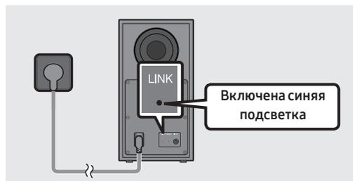
Светодиодный индикатор LINK прекращает мигать и непрерывно подсвечивается синим цветом, когда между Soundbar и беспроводным сабвуфером установлено соединение.
