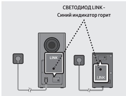
Если соединение установлено успешно, синие индикаторы на задней панели сабвуфера и динамиков объемного звука перестают мигать и непрерывно светятся.
