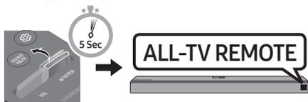
4. Soundbar құрылғысын әдепкі режимге (Samsung TV пультімен басқару) қайтарғыңыз келсе, дисплейде “SAMSUNG-TV REMOTE” жазуы пайда болғанға дейін **WOOFER** түймесін 5 секунд басып тұрыңыз.
