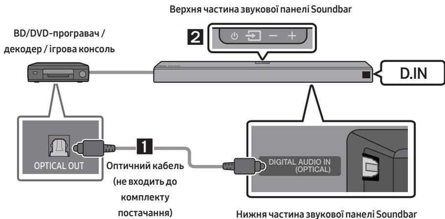
1. З'єднайте **DIGITAL AUDIO IN (OPTICAL)** на головному пристрої з роз'ємом OPTICAL OUT на вихідному пристрої за допомогою цифрового оптичного кабелю (не входить до комплекту постачання).
