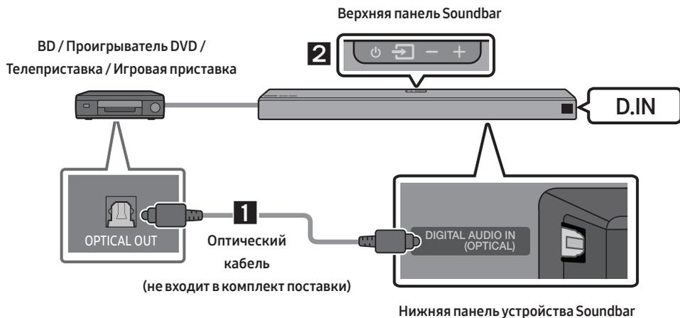
1. Подключите **DIGITAL AUDIO IN (OPTICAL)** на основном устройстве к разъему OPTICAL OUT на устройстве-источнике, используя оптический кабель (не входит в комплект поставки).
