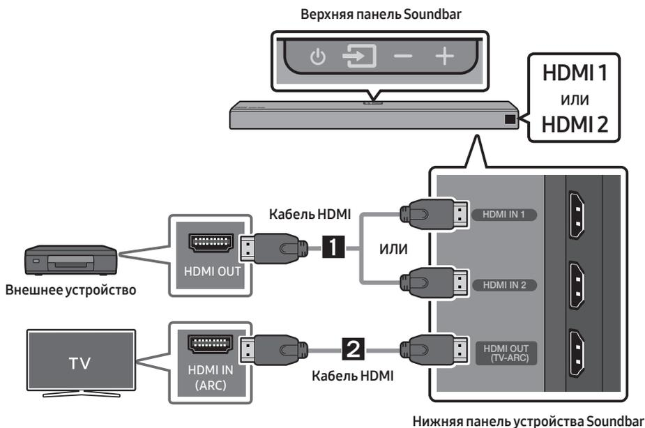
1. Подключите кабель HDMI с разъема **HDMI IN 1** или **HDMI IN 2** на нижней панели устройства Soundbar к разъему HDMI OUT на вашем цифровом устройстве.
