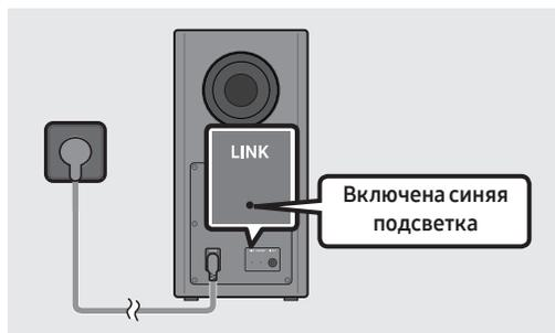
Светодиодный индикатор LINK прекращает мигать и непрерывно подсвечивается синим цветом, когда между Soundbar и беспроводным сабвуфером установлено соединение.
