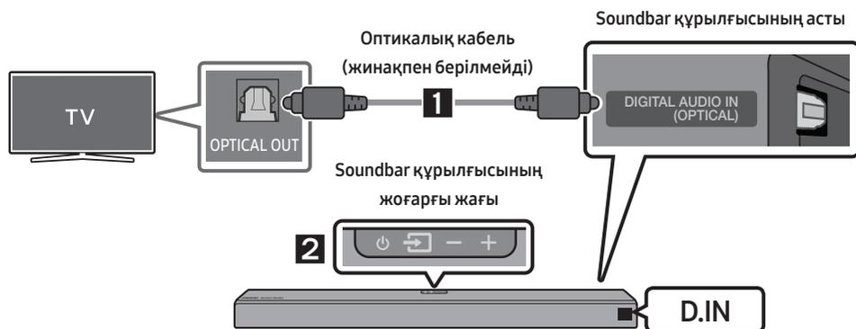
1. Soundbar құрылғысындағы **DIGITAL AUDIO IN (OPTICAL)** жалғағышын сандық оптикалық кабелі бар (жинақпен берілмейді) теледидардың OPTICAL OUT розеткасына қосыңыз.
