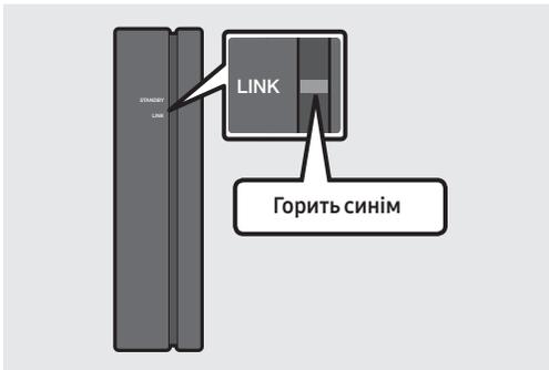
Після встановлення підключення між звуковою панеллю Soundbar та модулем бездротового приймача світлодіодний індикатор LINK припинить блимати й горітиме неперервно синім світлом.
