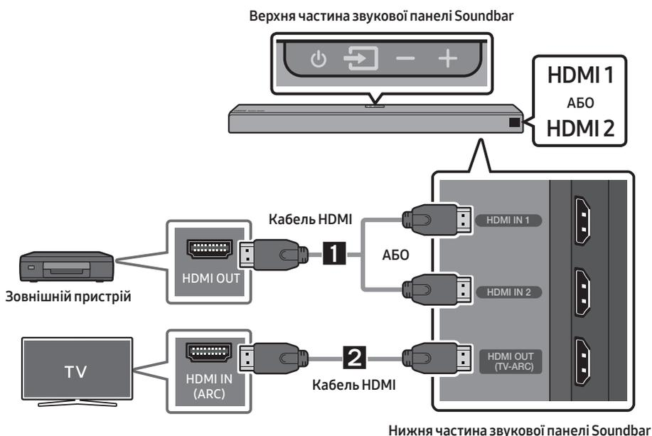
1. Підключіть кабель HDMI, що йде від роз'єму **HDMI IN 1** або **HDMI IN 2** у нижній частині звукової панелі Soundbar, до роз'єму HDMI OUT на вашому цифровому пристрої.
