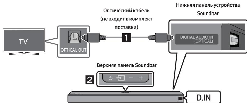
1. Подключите разъем **DIGITAL AUDIO IN (OPTICAL)** на устройстве Soundbar к разъему OPTICAL OUT на ТВ при помощи цифрового оптического кабеля (не входит в комплект поставки).
