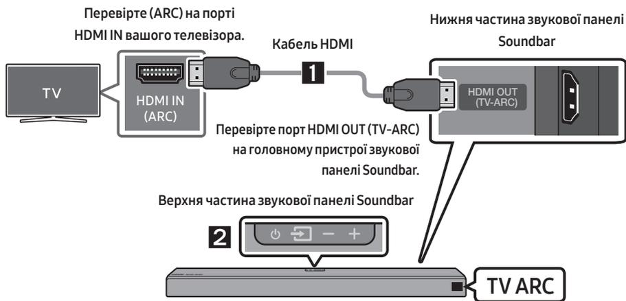
1. Увімкніть звукову панель Soundbar та телевізор, після чого підключіть кабель HDMI, як показано на зображенні.
