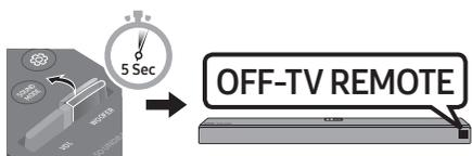
3. Если вы хотите управлять Soundbar с помощью пульта телевизора, переместите кнопку **WOOFER** вверх и удерживайте ее нажатой в течение 5 секунд до появления надписи **"ALL-TV REMOTE"** на экране устройства. Затем с помощью меню телевизора выберите внешние динамики.
