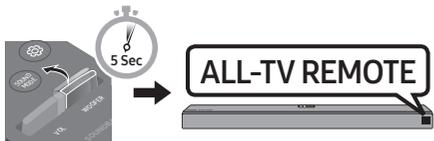
4. Якщо необхідно повернути звукову панель Soundbar до режиму за замовчуванням (керування за допомогою пульта дистанційного керування від телевізора Samsung), кілька разів натисніть вгору кнопку **WOOFER** та втримуйте її впродовж 5 секунд, поки на дисплеї не з'явиться напис «**SAMSUNG-TV REMOTE**».
