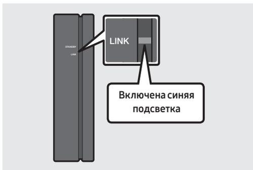
Светодиодный индикатор LINK прекращает мигать и непрерывно подсвечивается синим цветом, когда между Soundbar и беспроводным модулем приемника установлено соединение.
