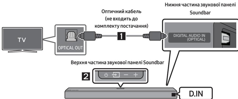
1. З'єднайте роз'єм **DIGITAL AUDIO IN (OPTICAL)** на звуковій панелі Soundbar з OPTICAL OUT на телевізорі за допомогою цифрового оптичного кабелю (не входить до комплекту постачання).
