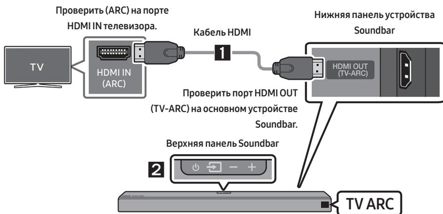
1. Включив устройство Soundbar и телевизор, подключите кабель HDMI, как показано на рисунке.
