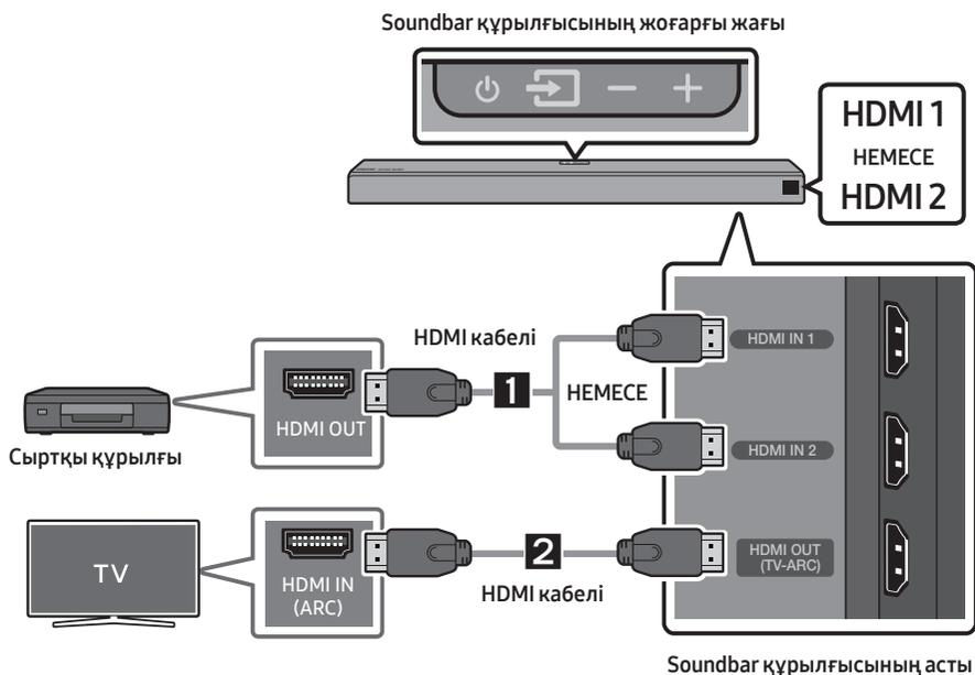
1. HDMI кабелін Soundbar құрылғысының төменгі жағындағы **HDMI IN 1** немесе **HDMI IN 2** жалғағышынан сандық құрылғыдағы HDMI OUT жалғағышына жалғаңыз.
