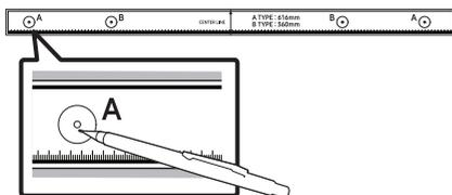
4. Используя сверло соответствующего размера, просверлите отверстие в стене на каждом обозначенном месте.
