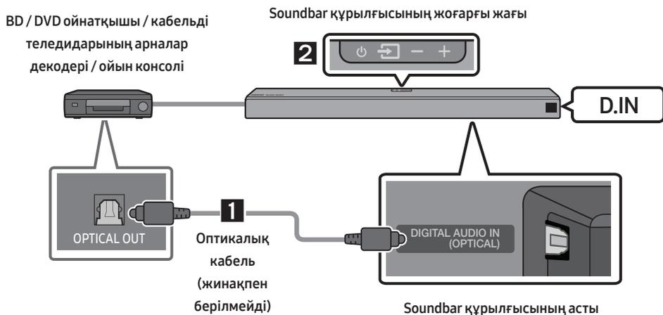
1. Негізгі құрылғыдағы **DIGITAL AUDIO IN (OPTICAL)** жалғағышын бастапқы құрылғының **OPTICAL OUT** жалғағышына сандық оптикалық кабелі (жинақпен берілмейді) арқылы жалғаңыз.
