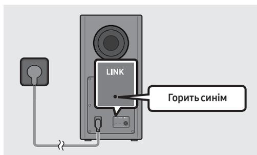
Після встановлення підключення між звуковою панеллю Soundbar та бездротовим сабвуфером світлодіодний індикатор LINK припинить блимати й горітиме неперервно синім світлом.
