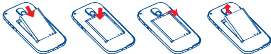
Вставьте и нажмите на аккумулятор, а затем закройте заднюю панель телефона.
