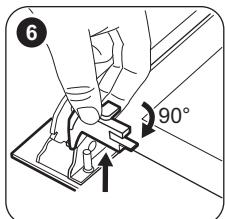
**6** Поверніть два фіксатори на 90° і вимітіть їх із гнізд.
