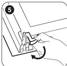
**5** Вивільть систему блокування для того, щоб витягнути внутрішню скляну панель.
