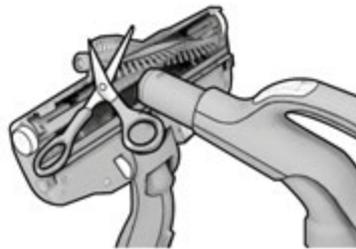
2. Bürstenrolle herausziehen und verwickelte Fäden mit einer Schere durchschneiden und entfernen. Mit dem Schlauchgriff die Düse absaugen. Zusammenbau in umgekehrter Reihenfolge.
