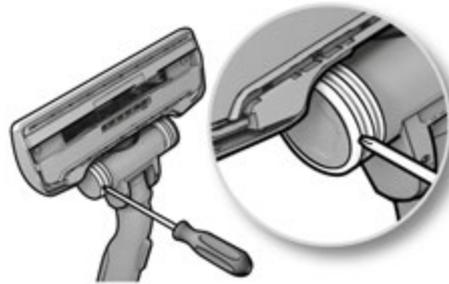
2. **Wenn die Räder blockiert sind**, zum Reinigen die Radabdeckung mit einem kleinen Schraubendreher abhebeln.
