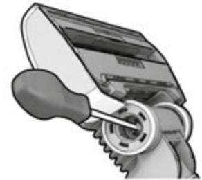
3. Die Radachse abschrauben und alle Teile reinigen. Zusammenbau in umgekehrter Reihenfolge.
