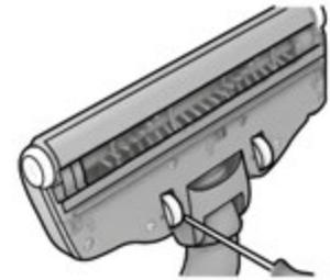
3. **Wenn die Räder verhaken**, sollten sie vorsichtig mithilfe eines Schraubendrehers entfernt und gereinigt werden.
