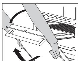
**3** Медленно закрывайте дверцу, пока фиксаторы не упрутся в прорези на дверце. Немного приподнимите дверцу и извлеките из гнезд шарниров.
