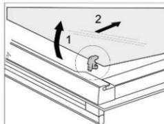
Возмите стекло дверцы за нижний край, немного приподнимите, чтобы оно освободилось из фиксаторов, и снимите.
