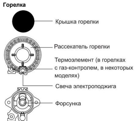
Горелка с газ-контролем
