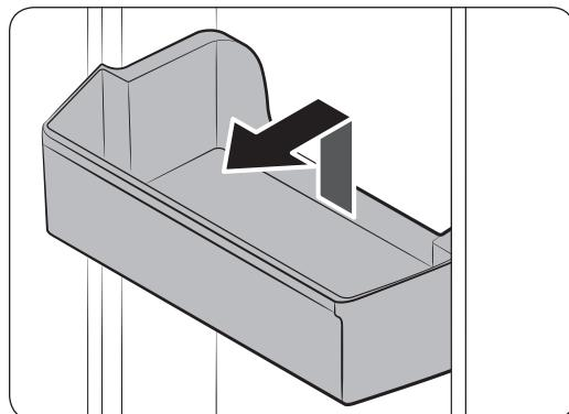
Слегка приподнимите и извлеките дверной лоток.
