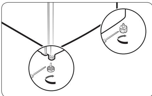
Выравняйте холодильник, вручную отрегулировав ножки. Для уменьшения высоты поверните ножки по часовой стрелке, а для увеличения – против часовой стрелки.
